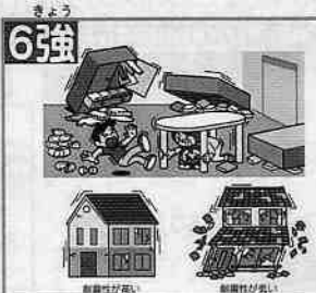
【震度6強】 ○はわないと動くことができない。飛ばされることもある。 ○固定していない家具のほとんどが移動し、倒れるものが多くなる。 ○耐震性の低い木造建物は、傾くものや、倒れるものが多くなる。 ○大きな地割れが生じたり、大規模なすべりや山体の崩壊が発生することがある。
