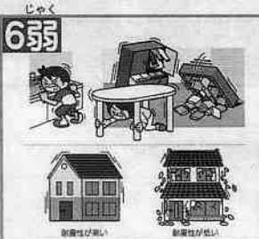
【震度6弱】 ○立っていることが困難になる。 ○固定していない家具の大半が移動し、倒れるものもある。ドアが開かなくなることがある。 ○壁のタイルや窓ガラスが破損、落下することがある。 ○耐震性の低い木造建物は、瓦が落下したり、建物が傾いたりすることがある。倒れるものもある。
